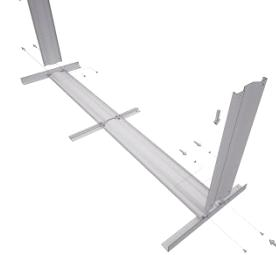
3. Далее винтами прикручиваем торцевую панель к боковой, а затем вторую торцевую панель прикручиваем к этой же боковой панели (как на рис. 11)
