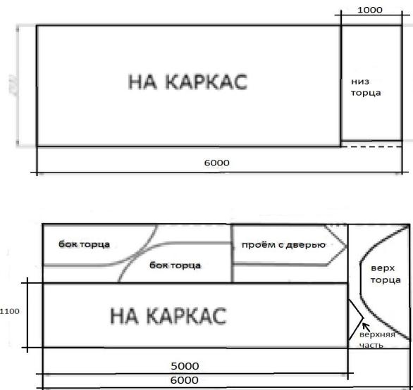
Положить торец на ровную поверхность так, чтобы фортка и дверь открывались вверх. Снять прозрачную защитную пленку с листа поликарбоната (ВНИМАНИЕ!!! приложить данный лист к торцу строго определенной стороной листа вверх, если такая сторона указана на поликарбонате) так как показано на рисунке, и прикрутить его кровельными саморезами. Рассек поликарбоната можно проводить строительным, либо обычным острым ножом.
