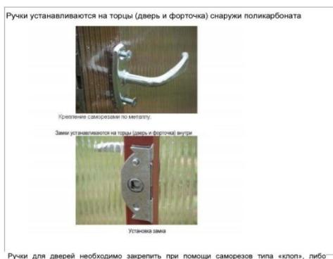
Ручки для дверей необходимо закрепить при помощи саморезов типа «клоп», либо болтами, предварительно просверлив отверстия.
